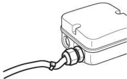
Fig. 1: Ventilatore montato in orizzontale, posa del cavo a U per evitare l'infiltrazione d'acqua.
